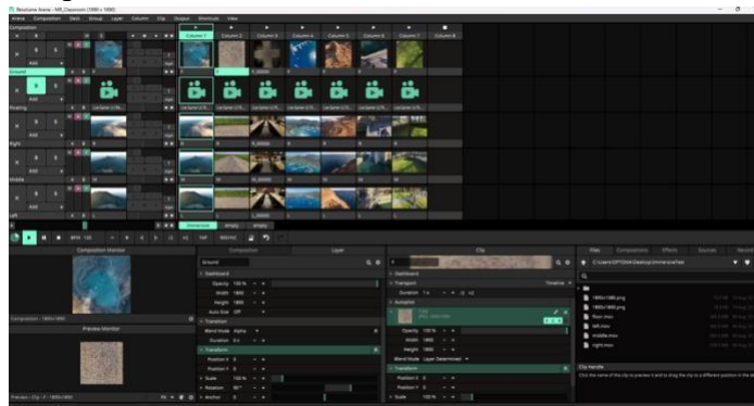
主機A在Resolume Arena 介面中對於左、正、右及地四牆面之影像設置
